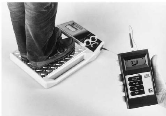
شکل ۳۶- اندازه‌گیری جریان القایی در محل کار کارگر با مبدل صفحه‌ای
