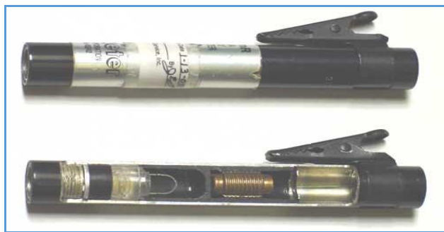
شکل ۸۹- دزیمتر جیبی نوع قرائت شونده Self-Reading
