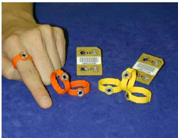
شکل ۸۷ - نمونه دزیمترهای ترمولومینسانس حلقه‌ای
