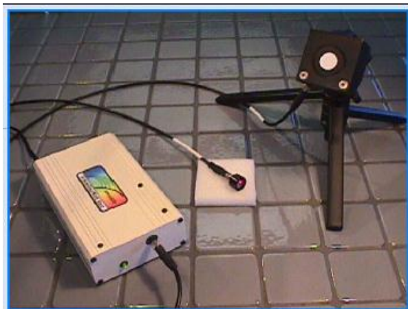
شکل ۱۴- نمونه دستگاه اسپکترو رادیومتر فرابنفش
