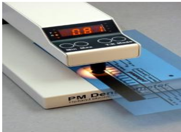
شکل ۸۴- دانسیتومتر جهت تعیین چگالی نوری فیلم
