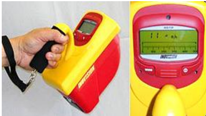
شکل ۷۸- یک نمونه دستگاه اندازه‌گیری اتاقک یون‌ساز جهت پایش محیطی
